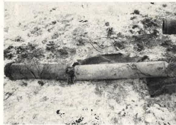
Abb. 15. Die aus dem Zündladerohr entfernte Zündladung nebst Paraffinpstopfen.
