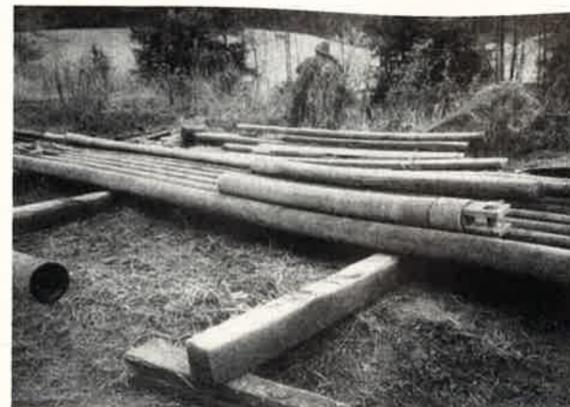
Abb. 6. Etwa 9 m lange Mannesmann-Rohre mit Gewinde und Muffen als Ladetorpedo. Obenauf das 2 m lange Kopfstück des Torpedos.
